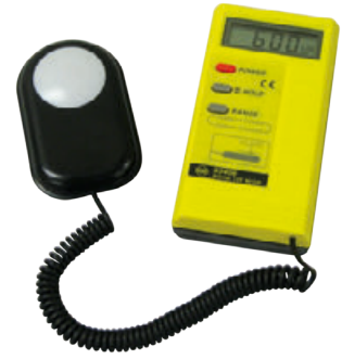
Figura 10 Fotómetro manual en el que se puede ver la parte para la detección de luz y la parte electrónica de lectura. Fuente: Lux meter for measuring illuminance, Hankwang, Wikimedia Commons.
