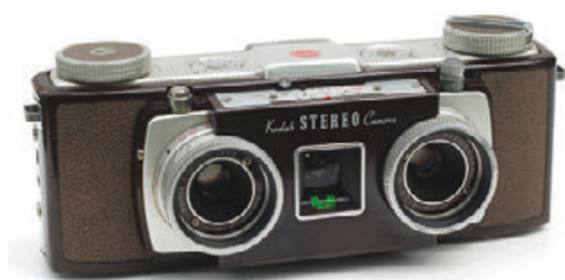
Figura 13 Ejemplo de una estereocámara: cámara de fotos con dos objetivos que están separados aproximadamente a la misma distancia que hay entre los dos ojos en los humanos. Fuente: Kodak stereo camera , John Kratz, Wikimedia Commons, CC BY-SA ( https://goo.gl/51EJF1 ).
