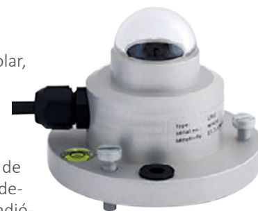
Figura 9 Piranómetro: radiómetro usado para la medida de la irradiación solar. Fuente: Piranómetro, Hukseflux, Wikimedia Commons.
