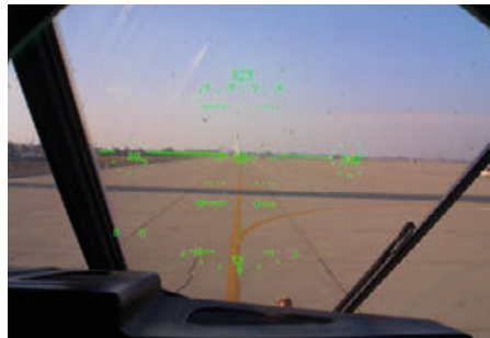
Figura 14 Head-up display o HUD en el panel frontal de la cabina de un avión. Fuente: C-130J co pilot's head-up display, Telstar Logistics, Wikimedia Commons, CC BY 2.0 ( https://goo.gl/zgYf5y ).
