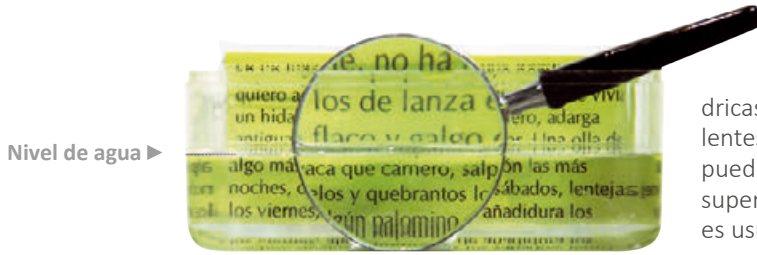
Figura 5 Variación del comportamiento de una lente convergente al cambiar el medio que la rodea. Fuente: Luis Gómez Robledo, Enrique Hita Villaverde, Miguel Ángel Martínez Domingo y M. a Josefa Yzuel Giménez.
