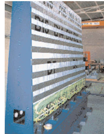
Criostato para el calorímetro electromagnético (arriba) y calorímetro hadrónico que se construye en Barcelona y Valencia (izquierda), ambos para el detector ATLAS del LHC
