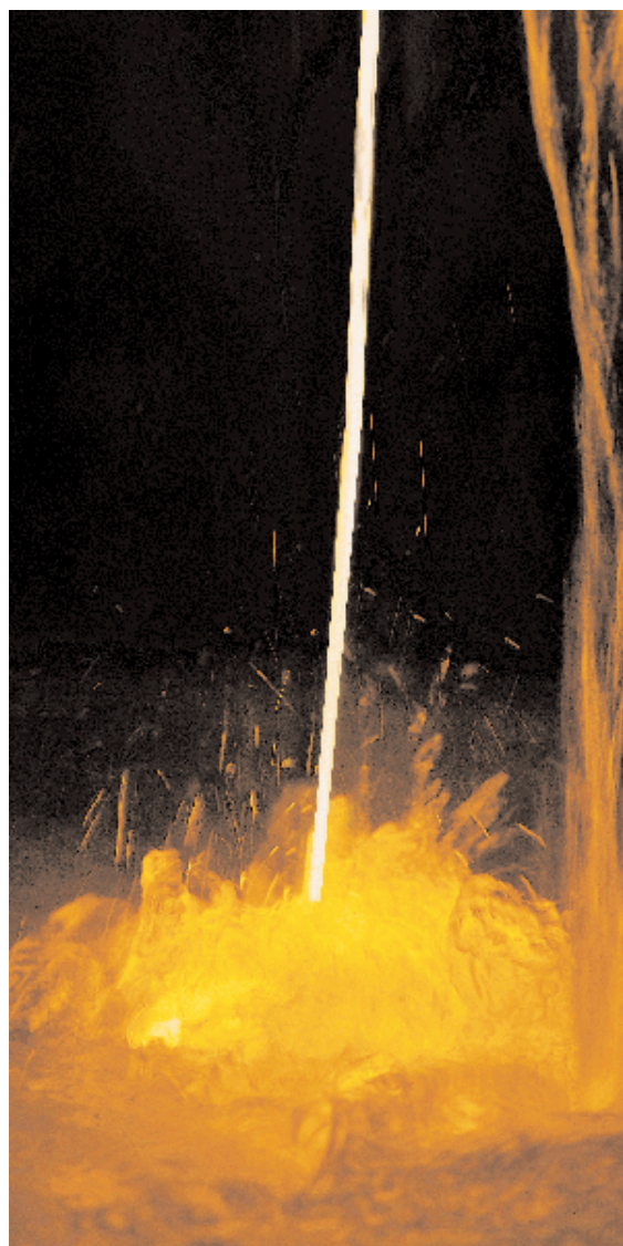
Enfriamiento de la mezcla fundida en agua en el proceso de fritado
