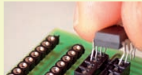
Montaje de microchip en un circuito.
