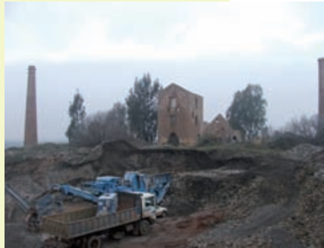
Retirada de áridos de una escombrera de granito.
