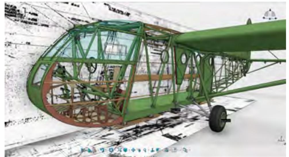
Reconstrucción digital del planeador Waco CG-4. Estaba hecho de madera y tela y podía transportar a trece soldados y armas, además del piloto y copiloto, y era muy silencioso. | IMAGEN Dassault Systèmes
