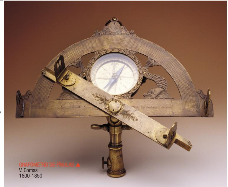
Instrumento utilizado para medir ángulos horizontales. Junto con una cadena de agrimensor o cualquier otro utensilio que mida distancias, permite la realización de planos y levantamientos topográficos. Este grafómetro perteneció a Pedro Serra y Bosch, arquitecto de la Real Hacienda y miembro de varias Academias, quien publicó diferentes tratados sobre agrimensura y topografía.
